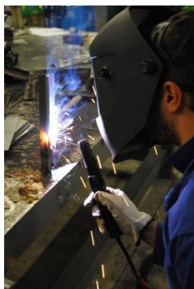
Soudage à l'arc
