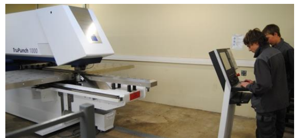
Mise en œuvre d'une poinçonneuse à commande numérique
